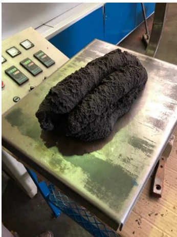
De warme massa die uit de extruder komt wordt gewogen, dan gaat het in de hydraulische pers en zijn er 4 dakpannen klaar.
