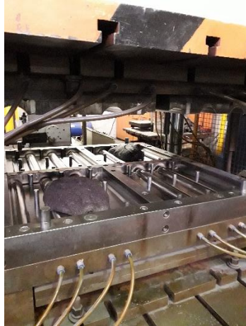
De warme massa die uit de extruder komt wordt gewogen, dan gaat het in de hydraulische pers en zijn er 4 dakpannen klaar.
