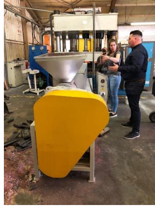
Linksboven gaat de mix van zand en plastic in de extruder, rechts zie je de extruder.
