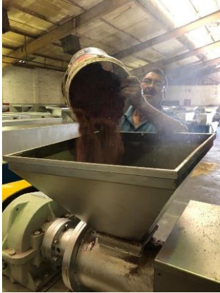
Linksboven gaat de mix van zand en plastic in de extruder, rechts zie je de extruder.
