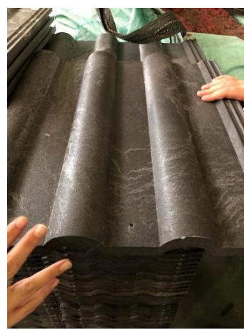
De warme massa die uit de extruder komt wordt gewogen, dan gaat het in de hydraulische pers en zijn er 4 dakpannen klaar.
