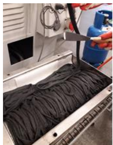
Het vullen van de dakpan/mal
